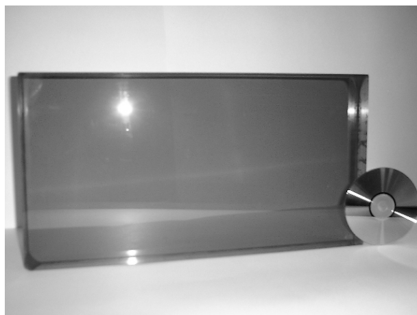
Рис. 1.5.12. Неодимовое фосфатное стекло: (а) - создано в компании Ноуа (США) для установки «NIF»; (б) – создано в научно-исследовательском и технологическом институте оптического материаловедения (НИТИОМ) для строящейся установки «Искра-6». Размер пластин 70 x 40 x 4 см.
